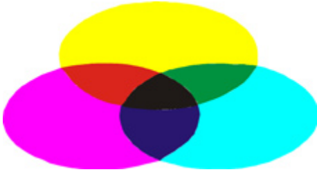
Abb. 32: Subtraktive Farbmischung Die CMY-Farben Cyan, Magenta und Yellow mischen sich zu Schwarz. Cyan und Yellow zu Grün, Cyan und Magenta zu Blau, Magenta und Yellow zu Rot. Farbanteile werden absorbiert und die Helligkeit nimmt ab. In der Praxis findet das CMYK-Modell Verwendung. K steht dabei für Black, denn ein reiner CMY-Druck hätte kein wirklich tiefes Schwarz, weswegen es zugesetzt wird.
