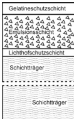
Abb. 18: Schematischer Aufbau eines typischen SW-Negativfilms
