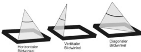
Abb. 33: Bildwinkel vertikal, horizontal und diagonal
